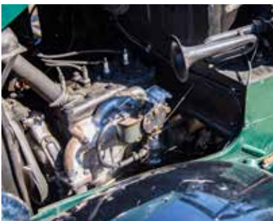
▲ De viercilinders van de Austin en de Fiat zijn niet gebouwd voor de eeuwigheid. Beide motoren hadden aanvankelijk slechts twee krukaslagers.
